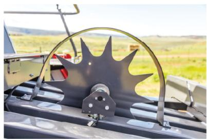
Sensor de rueda de estrella para medir la longitud de la paca y el recuento de láminas
