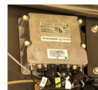
**AEstado del ACM y Bale Link:** el AGCO ConnectivityModule (ACM) es el dispositivo de telemetría utilizado para transmitir datos de la empacadora a la nube. Se muestra el estado de conexión y suscripción de ambos para que lo gestione el titular de la cuenta principal.
